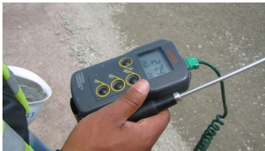
Vérification du température pour assurer la maniabilité
