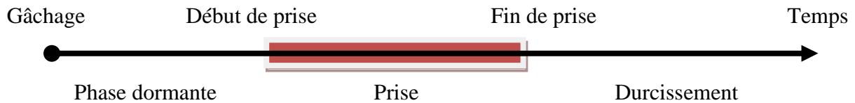
Figure 1.1 : Différentes phases de durcissement de la pâte de ciment
