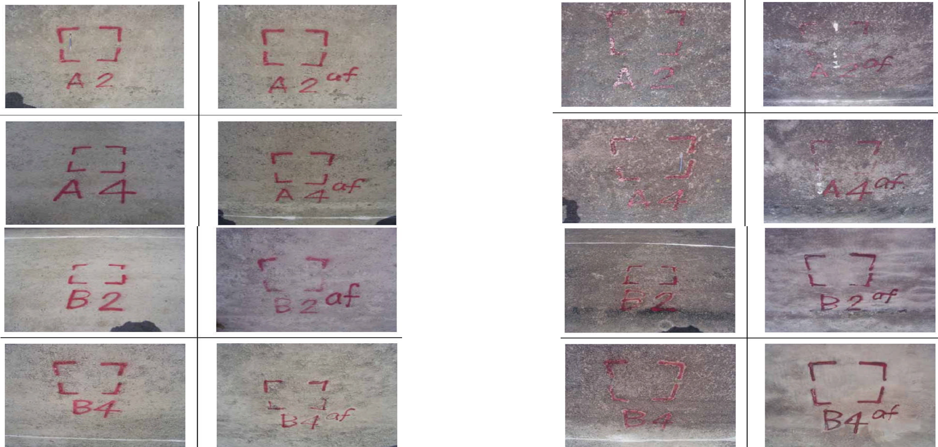
Figure 6.5. Emplacement des carottages dans les planches d'essai
