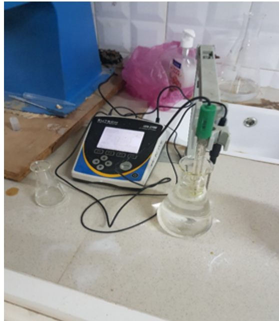
FIGURE 3.4: Valeur du PH est enregistrée durant tout le processus à l'aide du PH mètre
