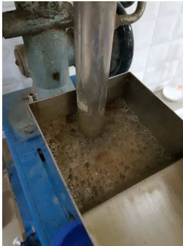
FIGURE 3.3: Agitation de la pulpe au sein de la cellule de flottation
