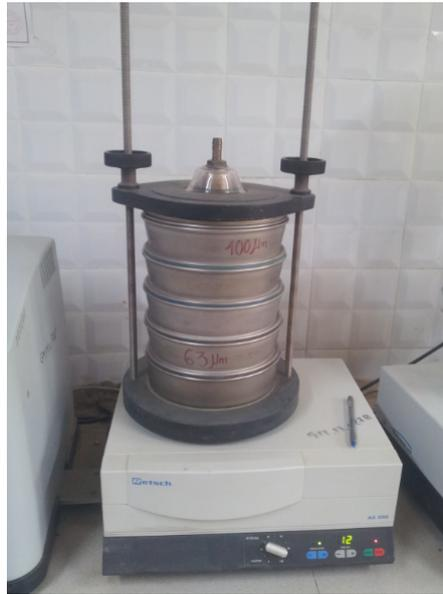
FIGURE 5.11 – Tamiseuse de type Retch
