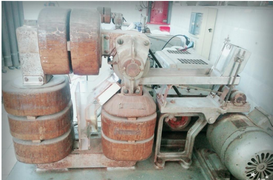
Figure 12: Séparateur magnétique SMHI (SMBI).
