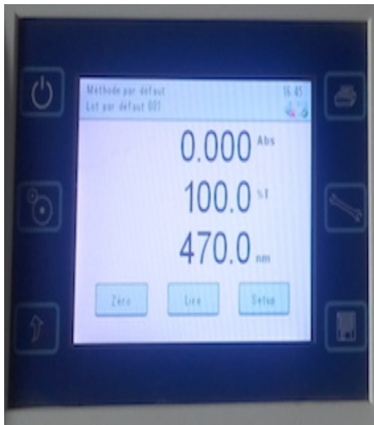
Fig.21 : Calibrage de l'appareil au zéro
