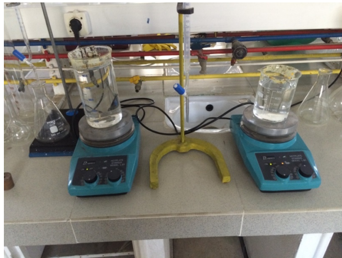
Fig.5 : Préparation des solutions A, B et C par Agitation Magnétique et chauffage à ébullition sur plaques chauffantes électriques
