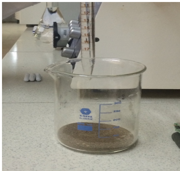
Fig.12 : Attaque du minerai phosphaté par l'acide sulfurique
