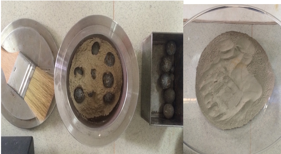
Fig.11 : Produit calciné après 30 minutes de broyage
