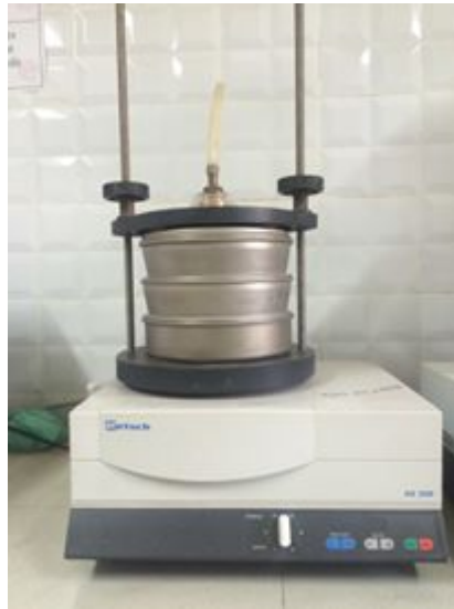
Fig.7 : Tamissage du produit calciné à une granulométrie inférieure à 250 microns
