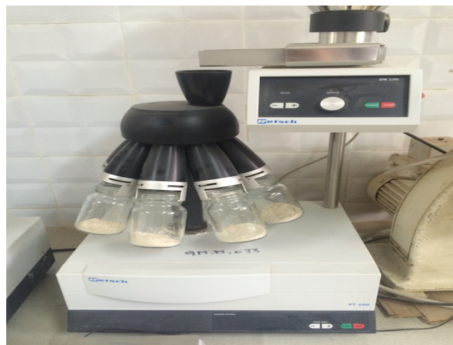
Fig.8 : Échantillonneur rotatif pour répartition homogène des échantillons
