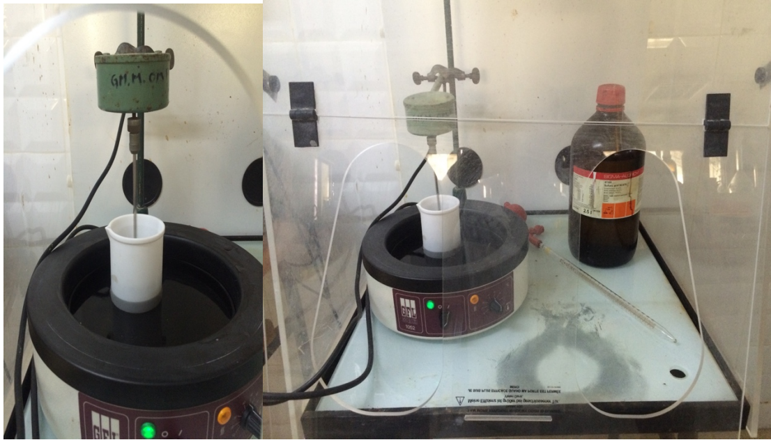
Fig.13 : Etape de mise en agitation des produits sous une hotte
