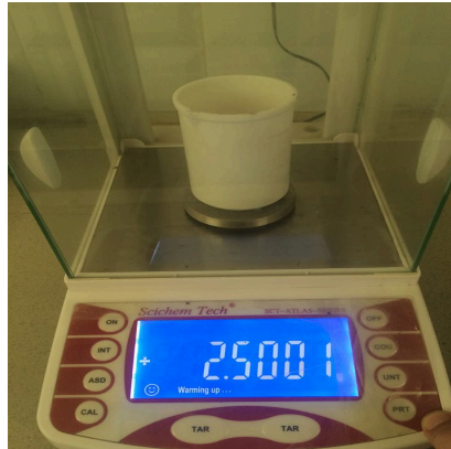
Fig.18 : Balance électronique sensible semi micro analytique à précision 0.001mg
