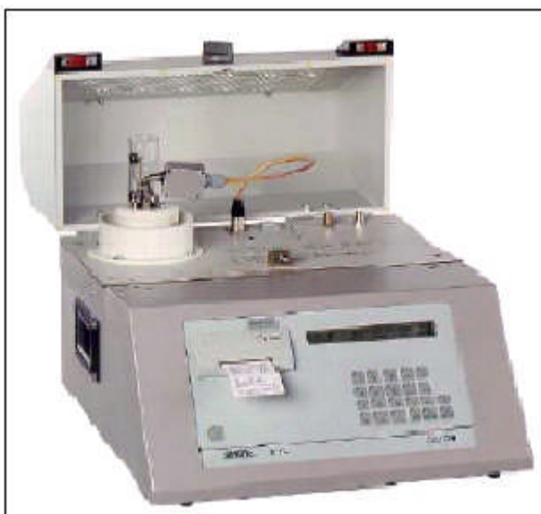
Figure IV.10 : Dieltest DLT utilisé dans la mesure du facteur de dissipation diélectrique et la permittivité relative
