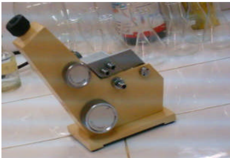
Figure IV.7 : Réfractomètre utilisé dans la mesure de l'indice de réfraction
