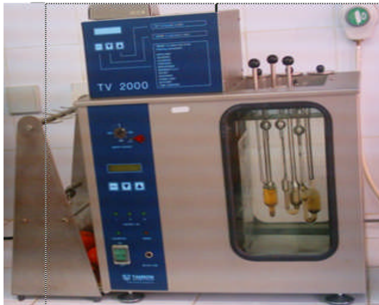
Figure IV.1 : Viscosimètre TAMSON (PMT) utilisé dans la mesure de la viscosité
