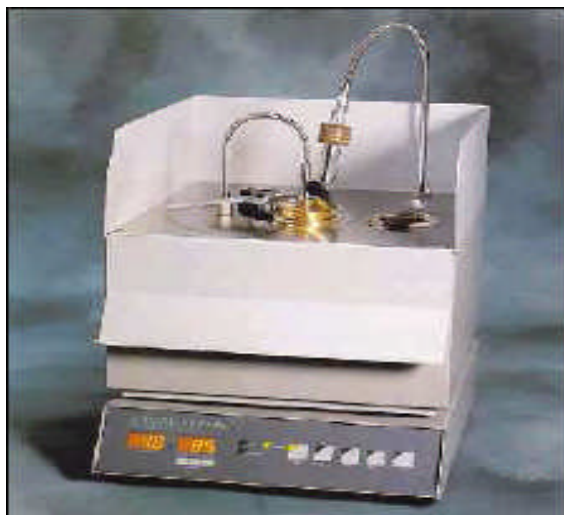
Figure IV.5 : Auto flash GALLEKAMP utilisé dans la mesure du point d'éclair
