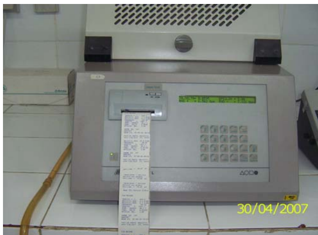
Figure III-3 : Pont de Scherring BAUER DTL
