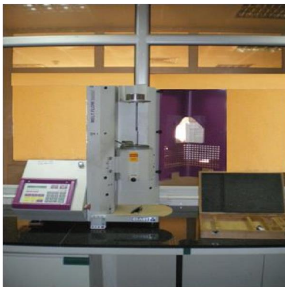
Figure 4.1 : Photo de plastomère utilisé pour l'analyse l'indice de fluidité.
