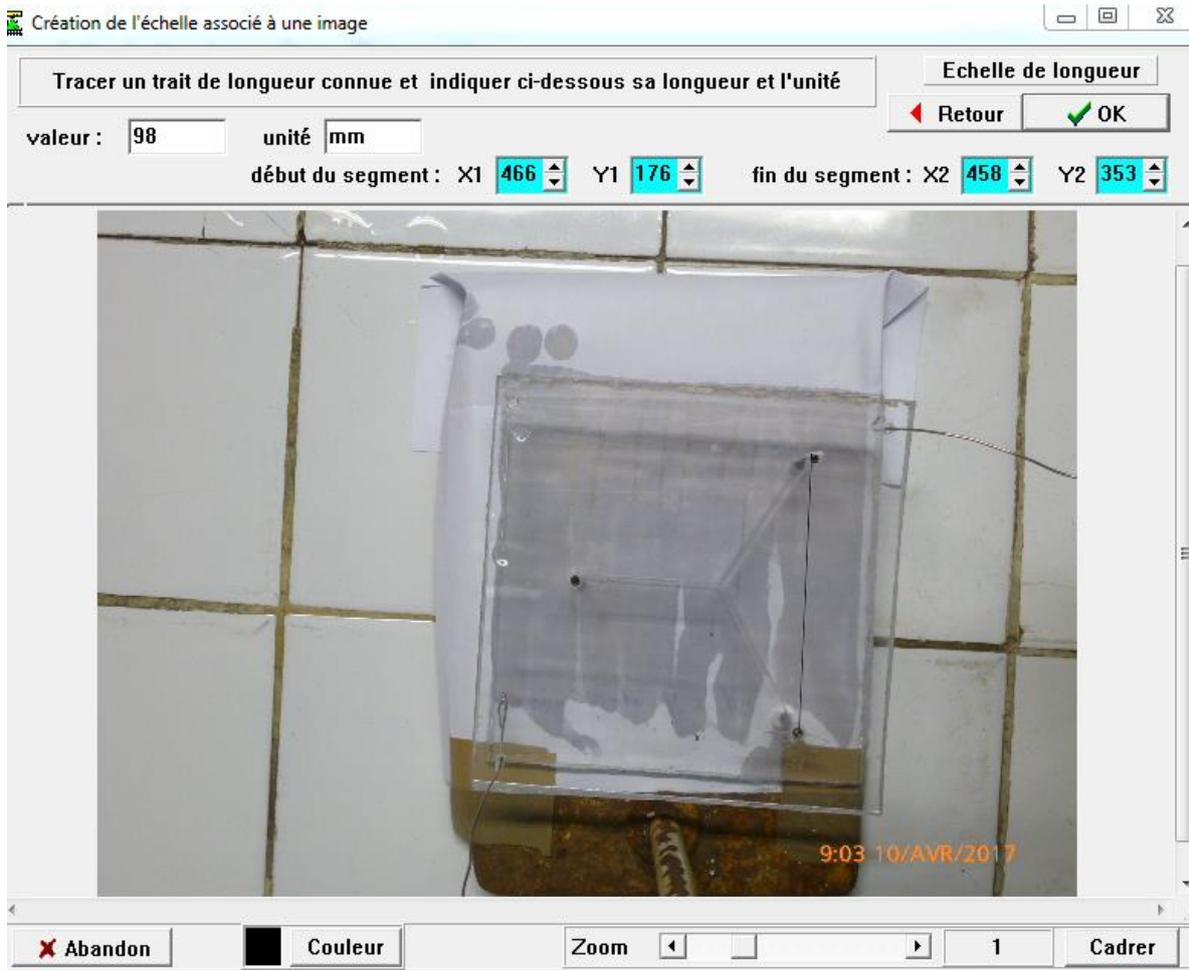
**Figure III.2 :** Une copie d'écran lors du processus d'étalonnage pour la mesure des longueurs de films
