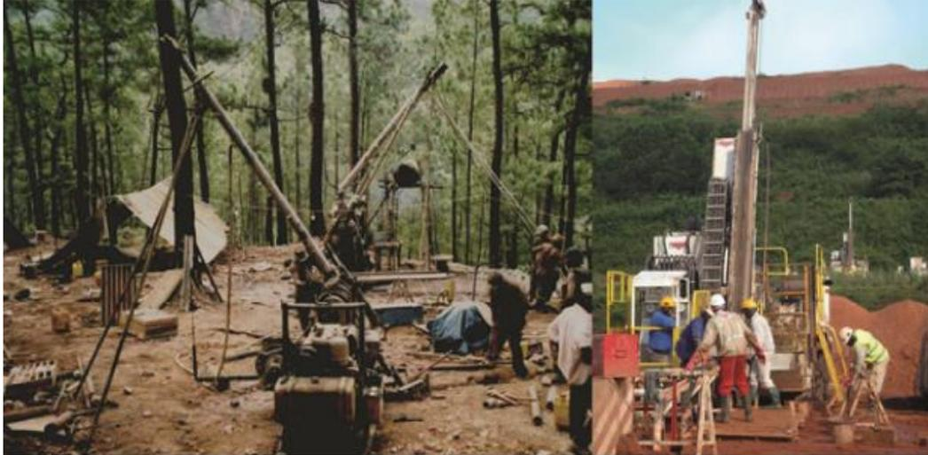
**Figure 4 :** Foration par carottage
