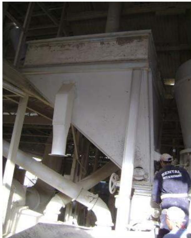
**Photo III.11** : *Trémie du broyeur de l'usine de Mostaganem.*
