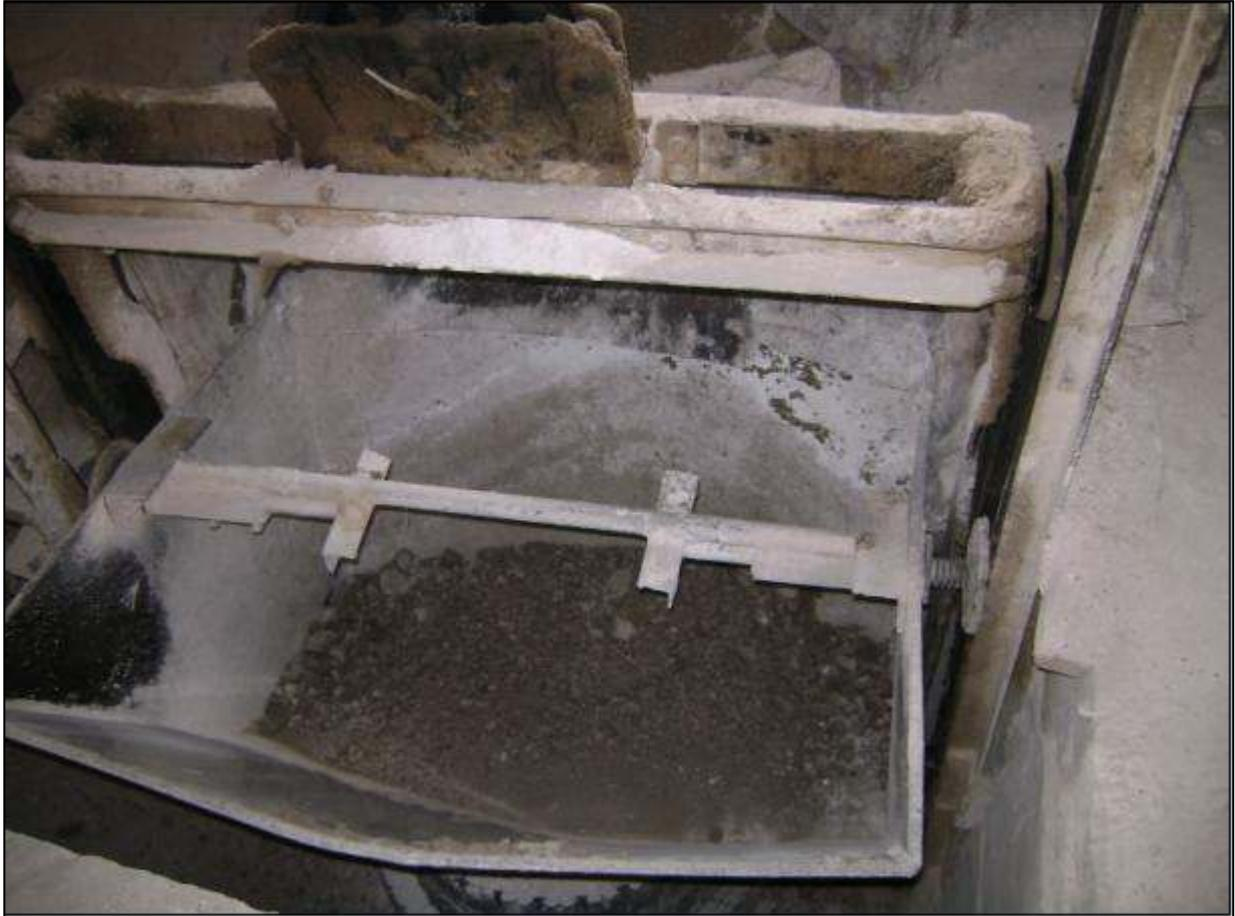
**Photo III.3 :** *Un skip de capacité 400 kg utilisé dans l'usine de Mostaganem.*
