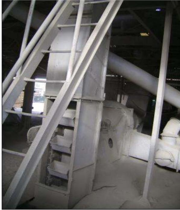
**Photo III.10** : *Elévateur à godets utilisé dans l'usine de traitement de Mostaganem.*
