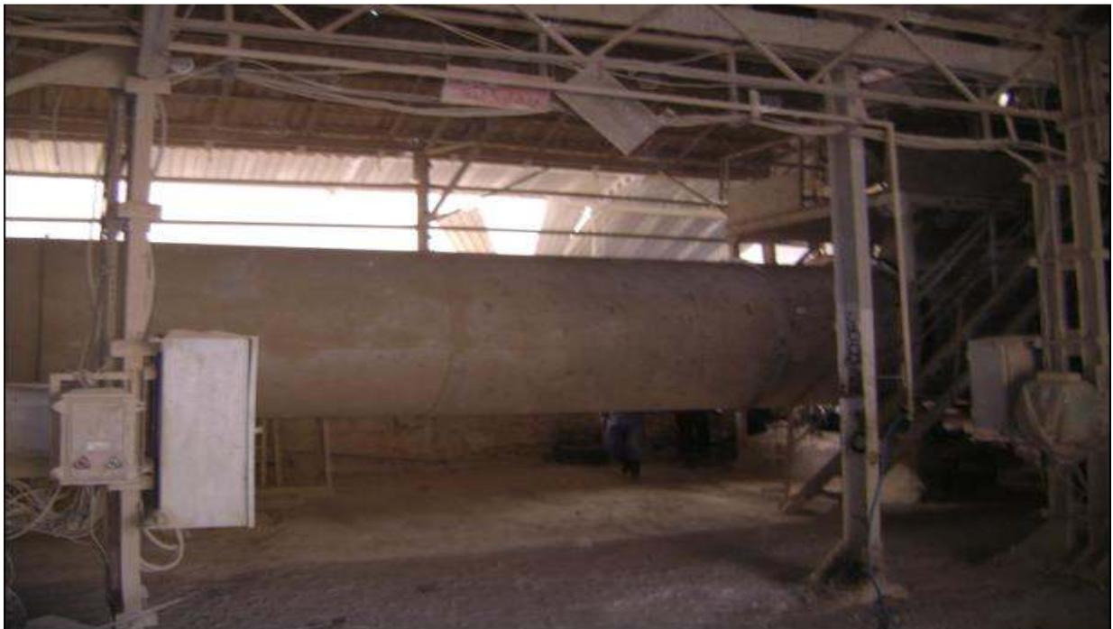
**Photo III.8 :** *Le sécheur rotatif utilisé dans l'usine de traitement de Mostaganem.*
