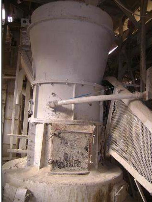
**Photo III.12** : Broyeur pendulaire PM-8 5 utilisé dans l'usine de traitement de Mostaganem
