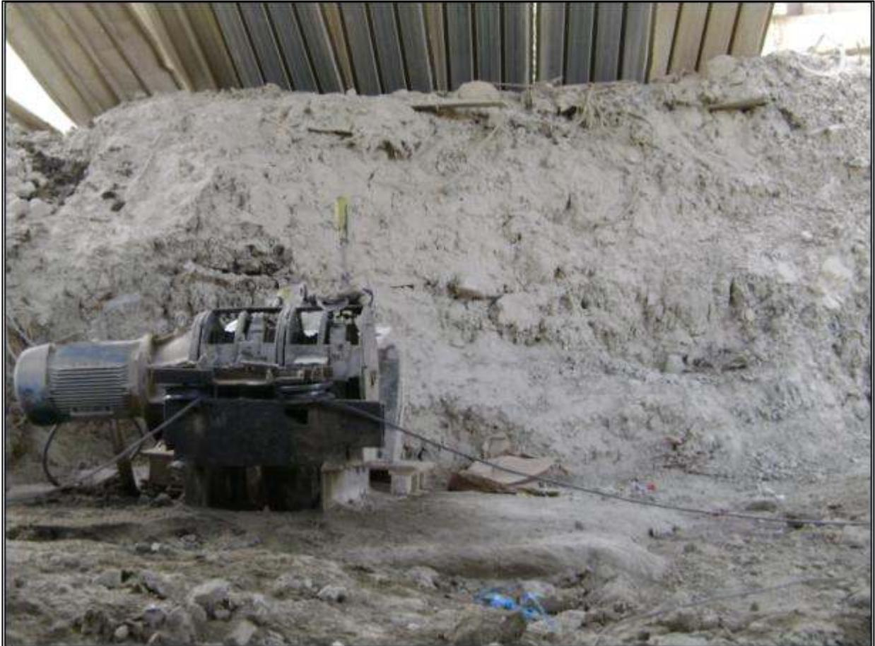
**Photo III.2:** Treuil qui alimente le skip au niveau de l'usine de Mostaganem.
