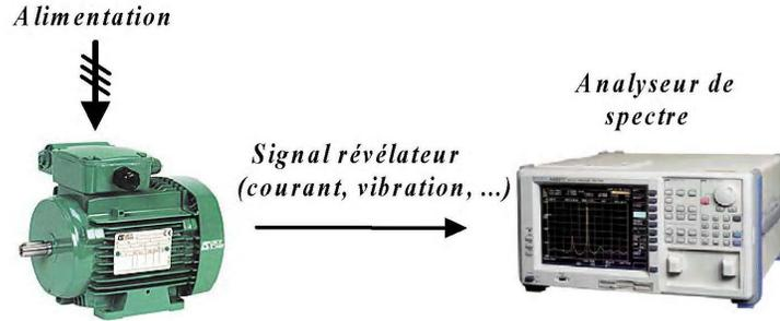
FIGURE I.12: Principe de la surveillance par analyse spectrale
