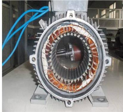
FIGURE IV.2: Stator de la machine asynchrone a cage d'écureuil.
