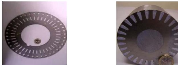
FIGURE I.3: *Circuit magnétique constituant le rotor*
