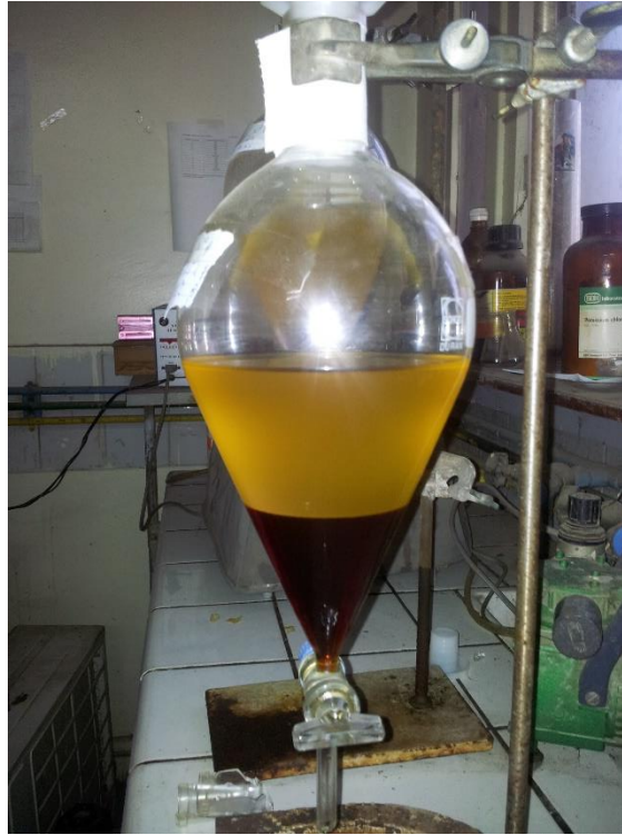
Figure 4.2 : Phase de décantation biodiesel/ glycérine
