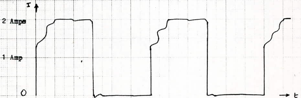
Fig. 4.5b : Forme du courant à la base du transistor de sortie Q_2 .
