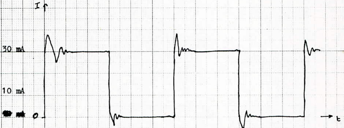
Fig. 4.5a : Forme du courant à l'entrée de l'étage de commande .
