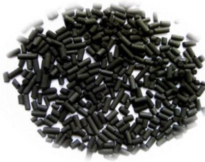
**Figure I.3 : Le charbon actif sous forme extrudée (CAE)**
