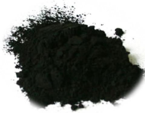
**Figure I.1 : Le charbon actif sous forme poudre (CAP)**
