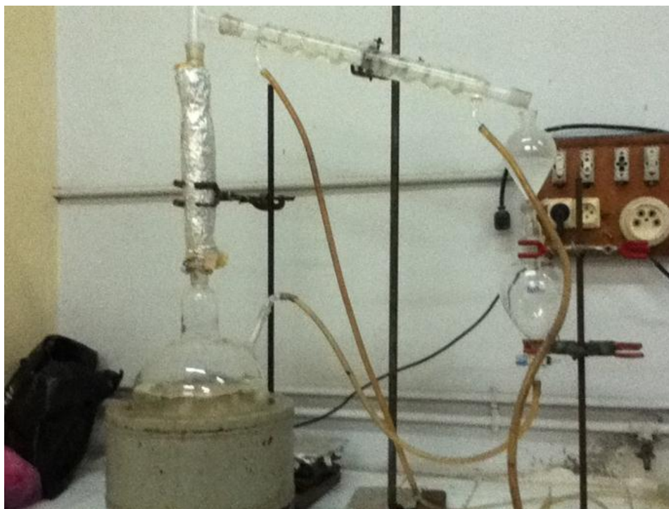
Figure 5.2: Dispositif expérimental d'entraînement à la vapeur d'eau à l'échelle laboratoire.
