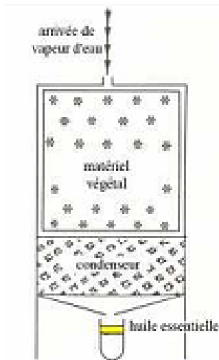
Figure 3.4: Schéma type d'une installation d'hydrodiffusion
