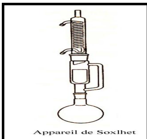
Figure I. 6 : Schéma de l'appareil de Soxhlet (Lucchesie, 2005)
