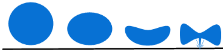
Figure 3.3: Évolution d'une bulle de cavitation à proximité d'une surface solide [59]
