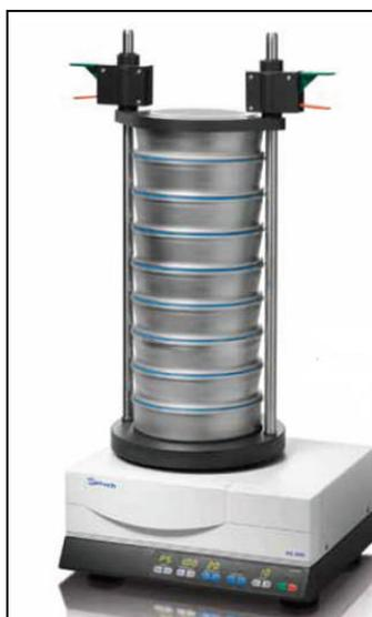
Figure 19 : la tamiseuse utilisée.
