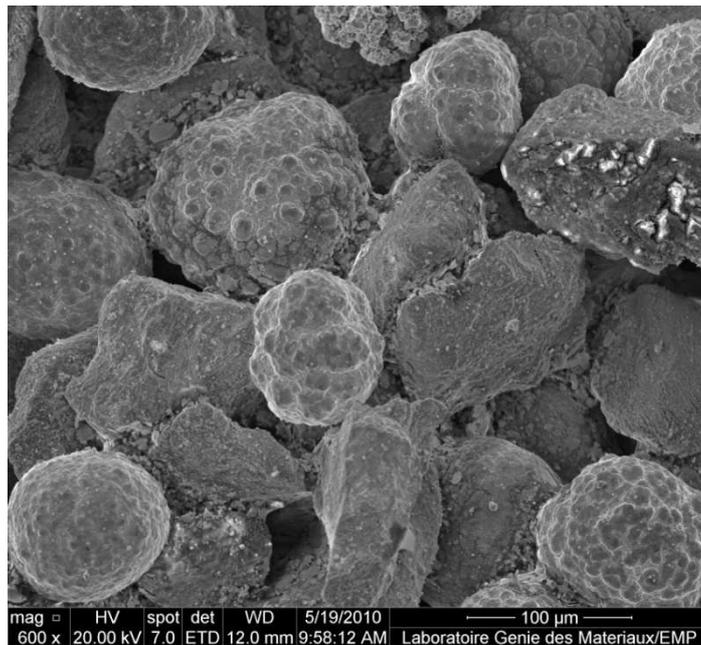
Figure 32 : Image MEB de la poudre retenue dans le troisième tamis ( $< 125\mu\text{m}$ ).
