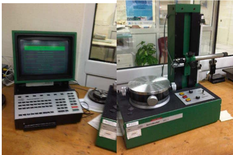
Figure.II.25 : machine à mesurer les défauts des pièces cylindriques utilisées pour mesurer les défauts de forme des alésages
