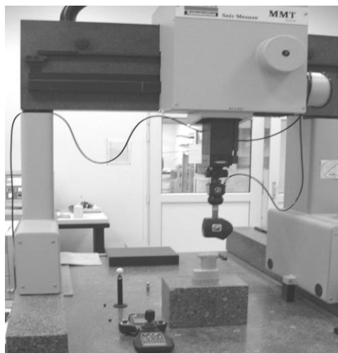
Figure.II.24: Machine à mesurer tridimensionnelle utilisée pour mesurer le diamètre moyen des alésages
