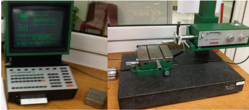
Figure.II.27: Rugosimètre utilisé pour effectuer les mesures de rugosité
