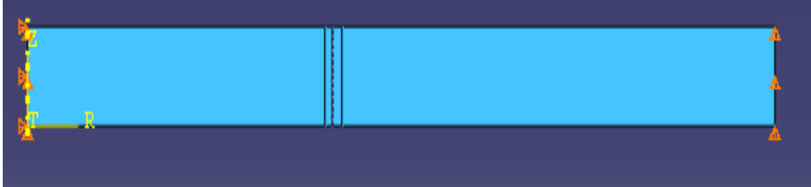
Figure.III.11 : Conditions aux limites du frettage avec axisymétrie
