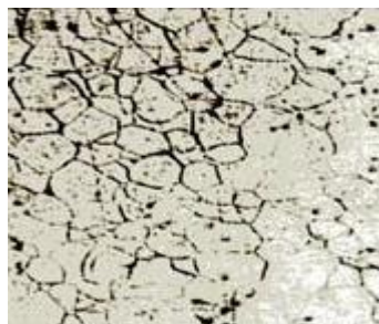
Figure V.9 : La nouvelle microstructure de notre alliage (petits grains)
