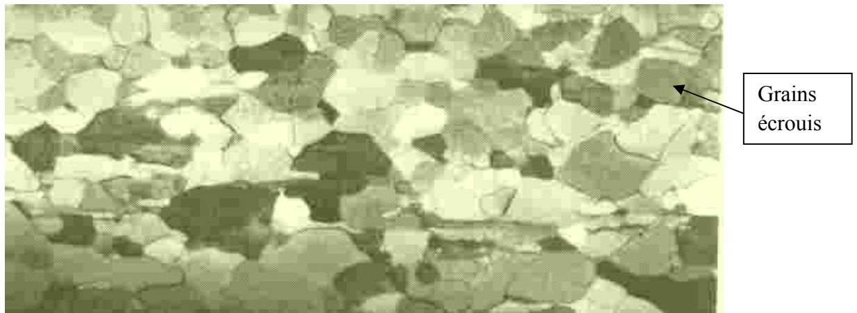
Figure V.6 : Les grains allongés lors du laminage.
