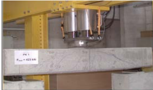
Fig III.4 Essais de flexion sur des colonnes [13] . Fig III.5 Essais d'effort tranchant sur des colonnes en béton [13].
