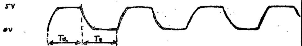
$T_1$  est donné par:  $V_{CC} = V_0 e^{T_1/R_1 C_1}$  -  $V_{CC} = 5V$  -  $V_0 = 0,6V$
