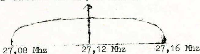
La fréquence porteuse 27,12 Mhz qui doit être aussi stable que possible est fournie par un oscillateur à quartz dont la dérive est très faible en fonction de la température.
