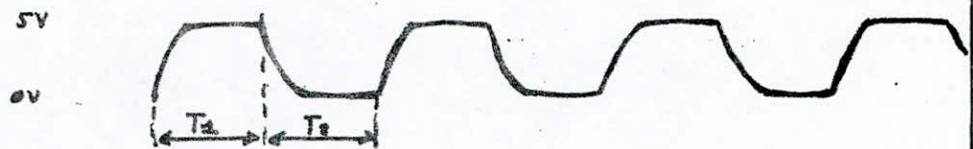
$T_1$  est donné par:  $V_{CC} = V_0 e^{T_1/R_2 C_2}$  -  $V_{CC} = 5V$  -  $V_0 = 0,6V$
