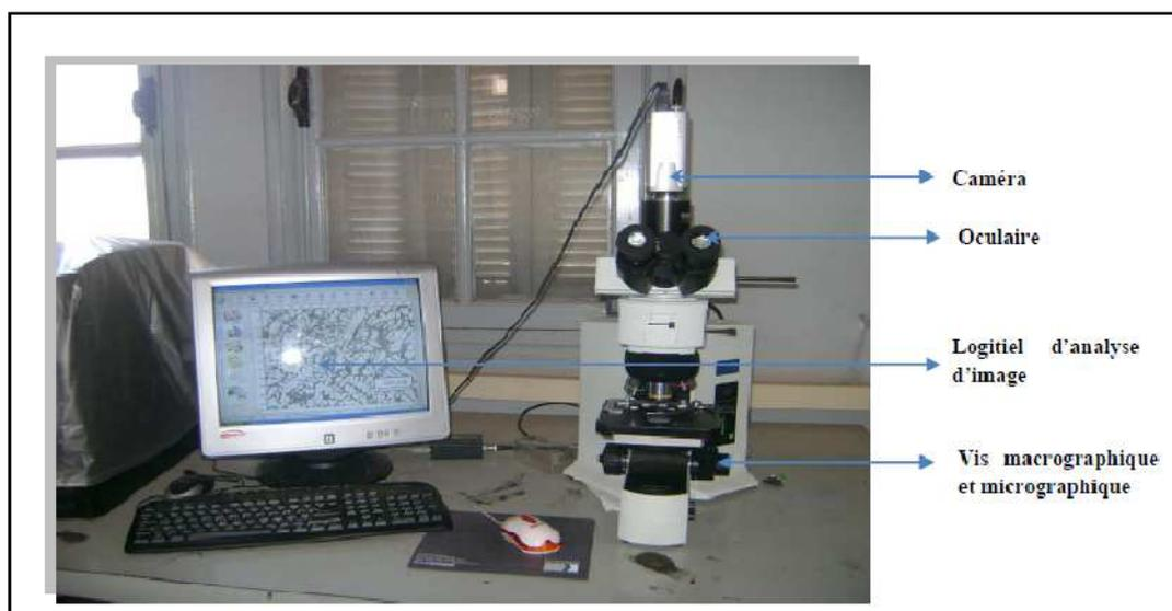
*Figure III-12. Microscope optique OLYMPUS XB51M, (ENP, laboratoire de métallurgie).*
