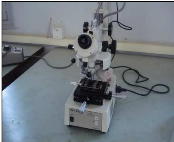
*Figure III-13. microduromètre (Vickers).*
