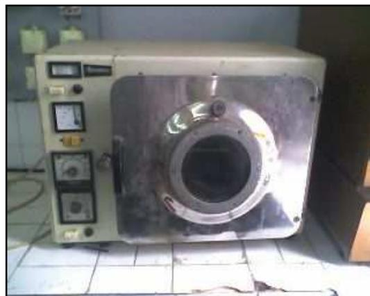
Figure III-8. Étuve à résistance électrique Heraeus de 400°C, (ENP, laboratoire de métallurgie).
