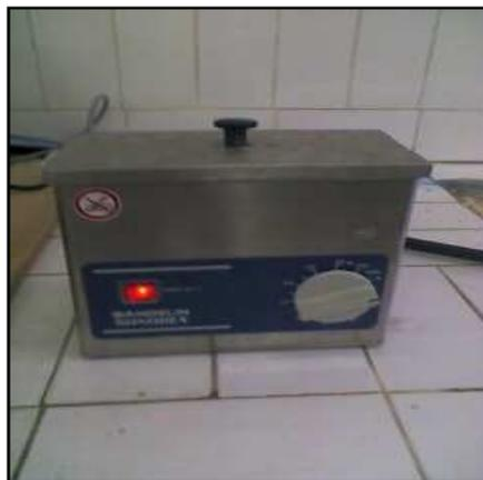
*Figure III-11. Nettoyeuse ultrasonique, BANDELIN SONOREX (ENP, laboratoire de métallurgie).*
