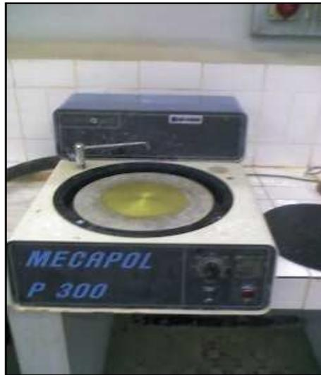
*Figure III-10. Polisseuse de finition MECAPOL P300, (ENP, laboratoire de métallurgie).*
