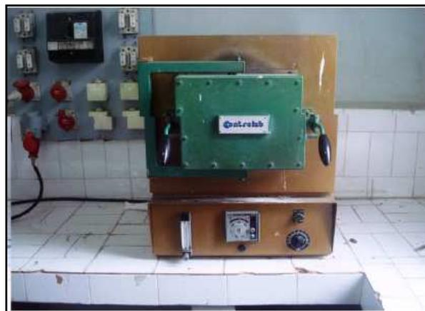
*Figure III-6. Four à résistance électrique Controlab, de 1200°C (ENP, laboratoire de métallurgie).*
