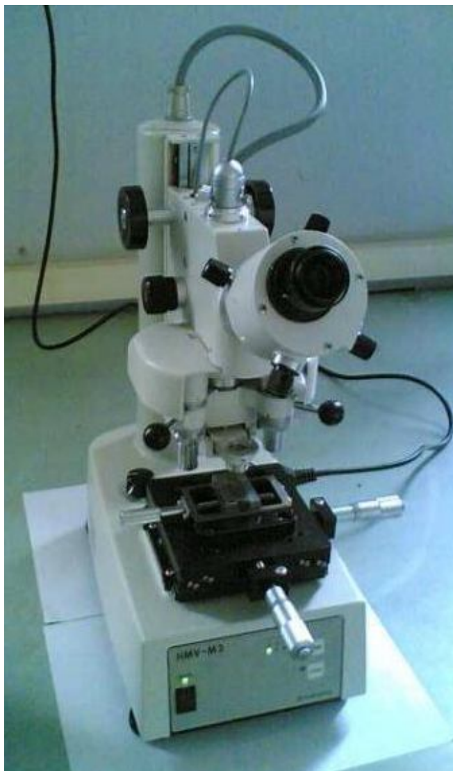
Figure IV-7: Microduromètre SHIMADZU HMV-M
