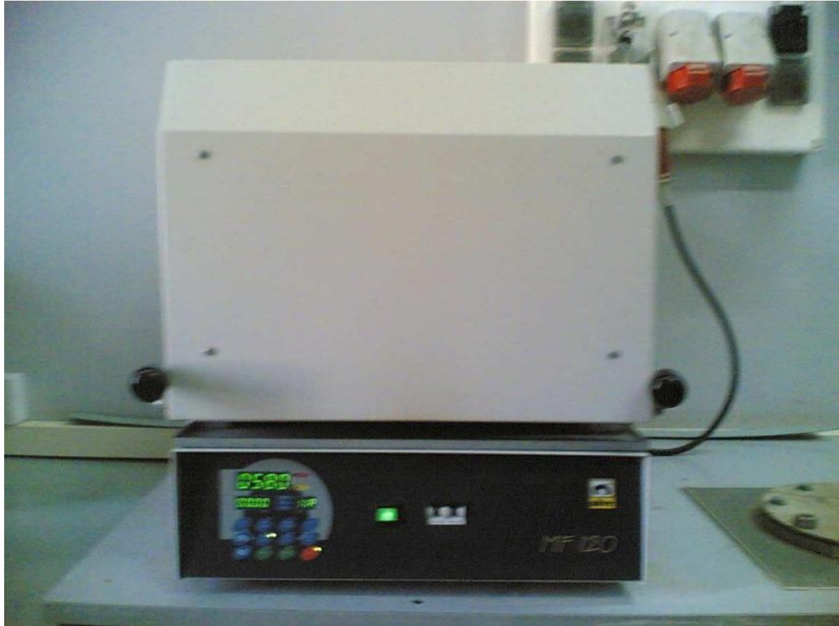
Figure IV-5: Four à moufle type NUVE MF 120 utilisé pour les traitements thermiques.
