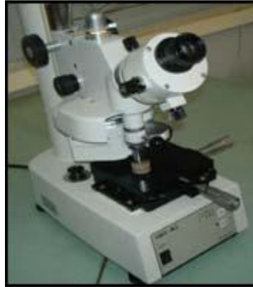
Figure III .10 : Microduromètre INSTRONWOLPERT TESTOR [4].
