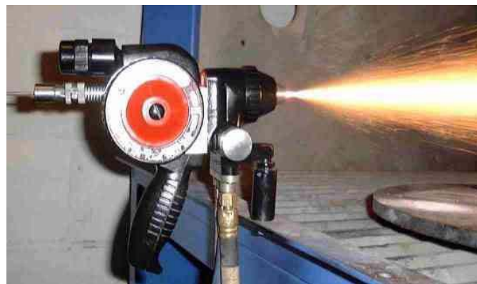
Figure III .2 : Pistolet de projection à arc électrique « Arc spray 234 » ayant servi à la projection de l'acier inoxydable 55 E [5].
