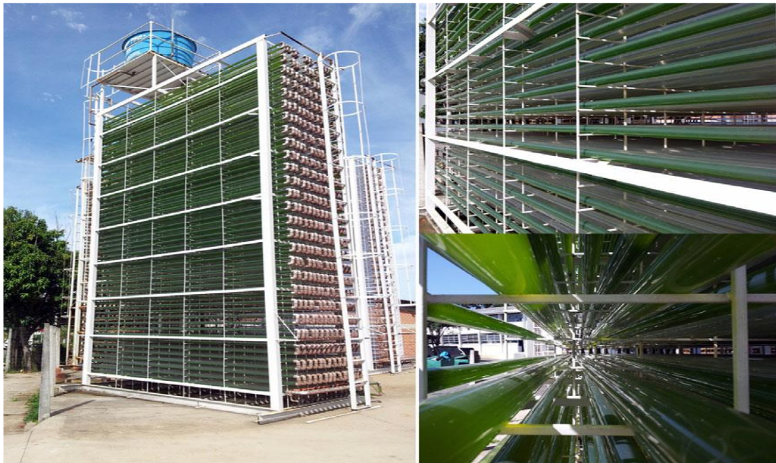
Figure 1.5: Photobioréacteur à échelle industrielle (Silva et al., 2015).
