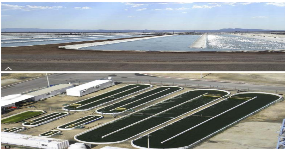
Figure 1.4: Système de culture des microalgues à ciel ouvert de type piste de course (Open pond raceway) (Barry et al., 2016)
