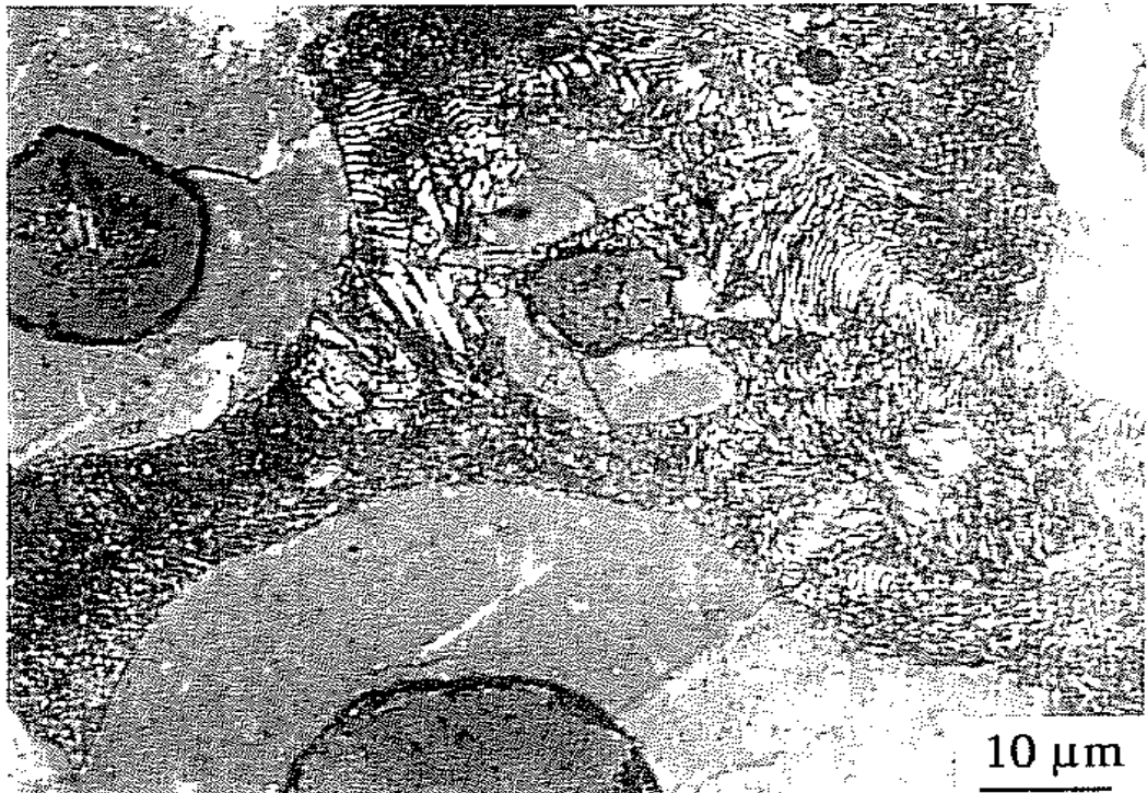
Figure (4.2). Perlite présente dans une fonte GS à matrice ferrito-perlitique [20]
