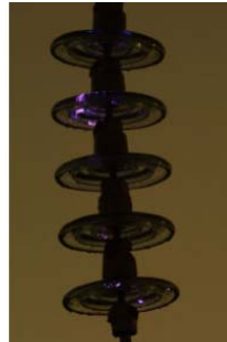
Figure I.3. Isolateur non uniformément pollué.
