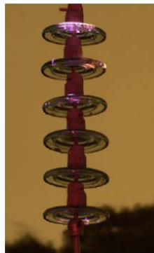
Figure I.1. Isolateur uniformément pollué.
