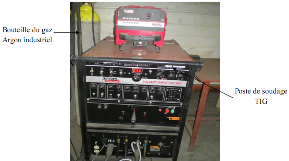
Figure (III.1) : Poste de soudage TIG
