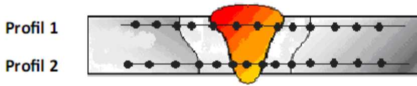
Figure IV.B.9 : Schéma du balayage de la microdureté.
