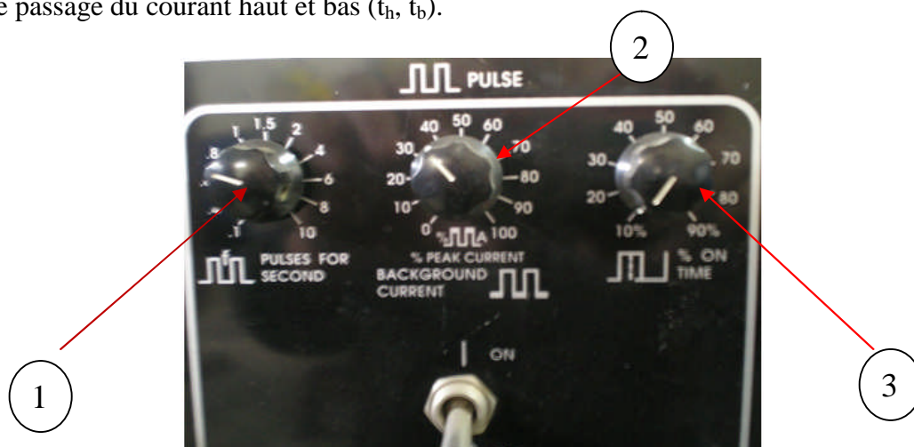
Figure IV.A.2 : Le tableau de bord d'un générateur de soudage TIG / GTAW (Partie de TIG pulsé)
