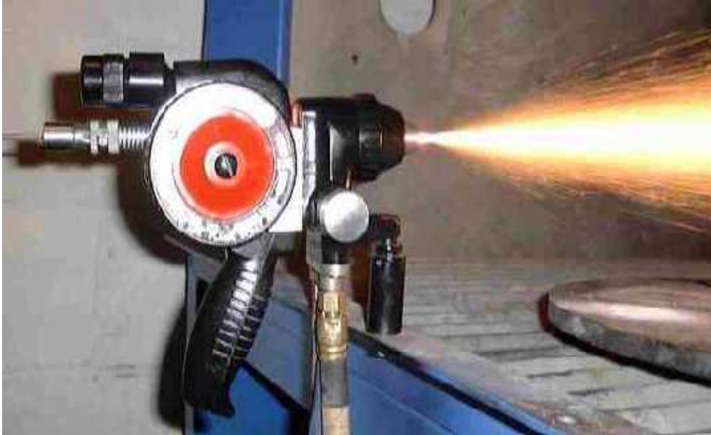
Fig.II-18 : Pistolet de projection à arc électrique « Arc spray 234 »[17]
