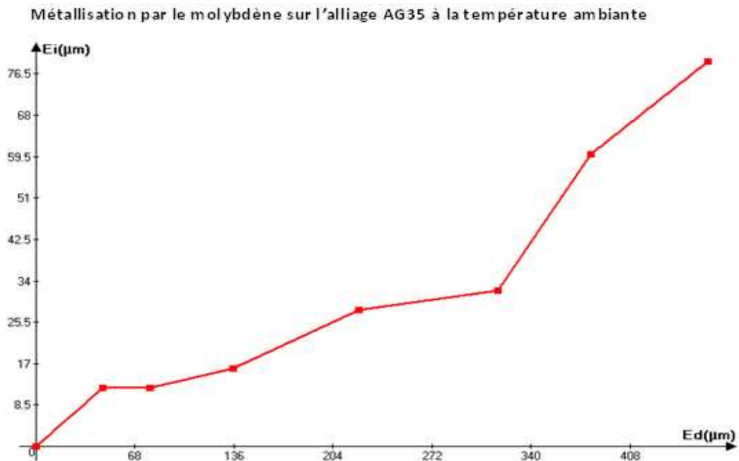
Fig. III-52 : graphe représente l'évolution de l'épaisseur de dépôt ( E_d ) et de l'interface ( E_i ) en fonction du temps
