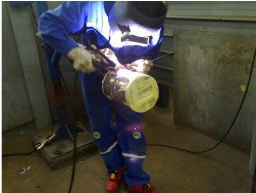
Figure III-4 : Soudage GTAW avec double protection gazeuse. (ENGTP)
