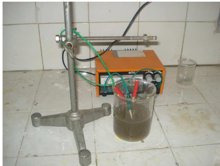
Figure IV-1 : Schéma + Dispositif de l'attaque électrolytique. (ENSP)
