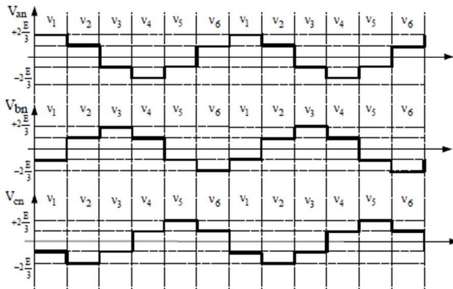
Figure II.25 : Tensions par phase avec un fonctionnement en pleine onde [8].
