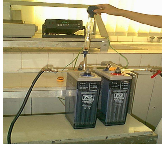
Figure 4.1.d : Photo de la mesure de la densité à l'aide d'un densimètre
