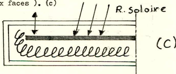
En fin de compte, la surface absorbante reçoit l'énergie émise par le soleil en surcroît de la moitié du rayonnement de la vitre.
