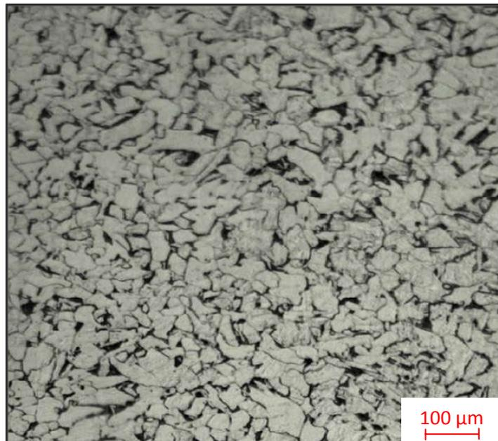
**Figure IV.4 :** Micrographie de la zone à gros grains.
