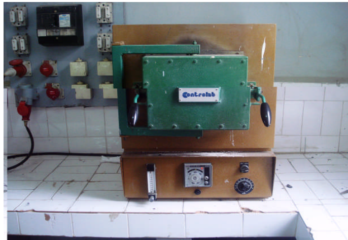
Figure III.7 : Le four à résistance utilisé.
