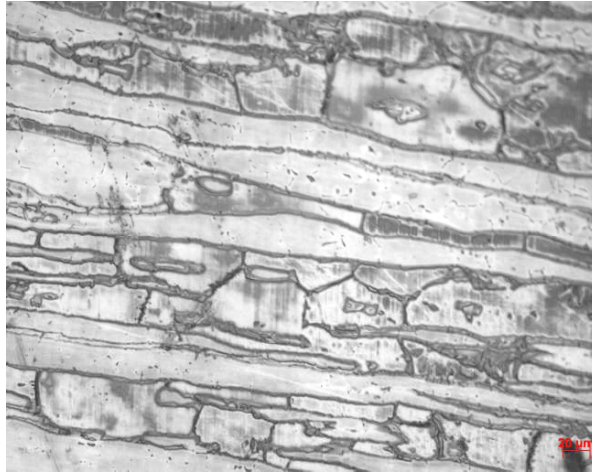
Figure IV.7: Micrographie optique du métal de base pour 100 h de maintien.
