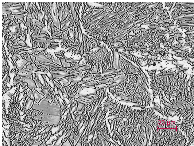
Figure IV.15: Micrographie optique de la zone fondue pour 50 h de maintien.
