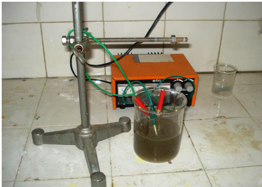
Figure III.9 : Dispositif de l'attaque électrolytique.
