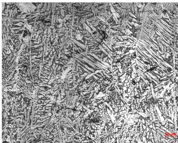
Figure IV.4: Micrographie optique de la zone fondue.
