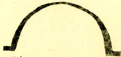
Fig. 10- VARIATION d'épaisseur par soufflage ou aspiration libres -
