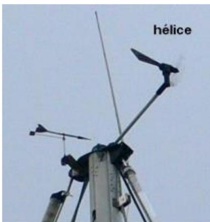
Figure 1.6a: Anémomètre à hélice [10]
