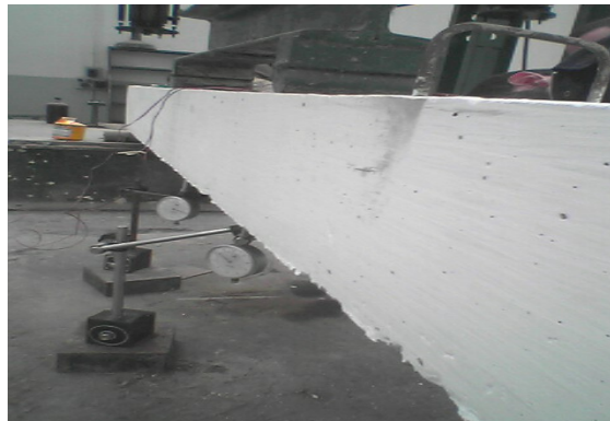
Fig.4.24 Emplacement des comparateurs
