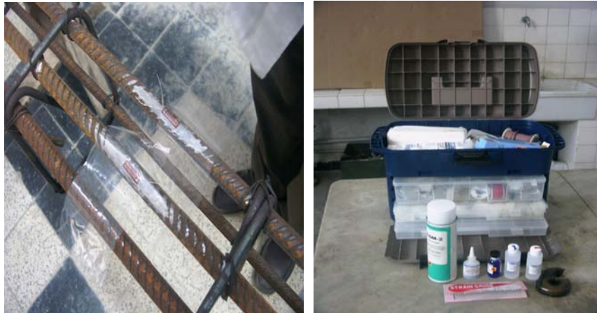
Fig. 4.28. Mise en place des jauges
