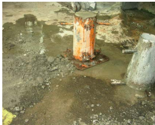
Fig.4.14 Confection des éprouvettes et mesure de l'affaissement au cône d'Abrams
