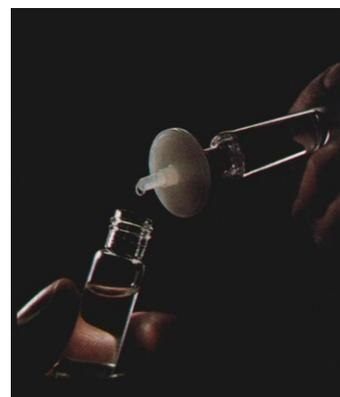
Figure IV- 1 : Filtre stérilisant (ou filtre à seringue) (0,45 µ m)
