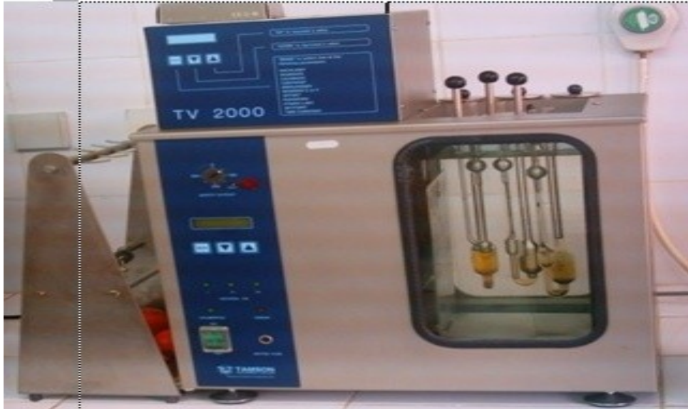
Figure II.9 : Viscosimètre TAMSON (PMT) utilisé dans la mesure de la viscosité
