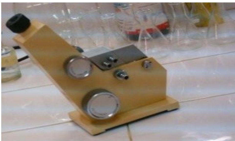
Figure II.15: Réfractomètre utilisé dans la mesure de l'indice de réfraction
