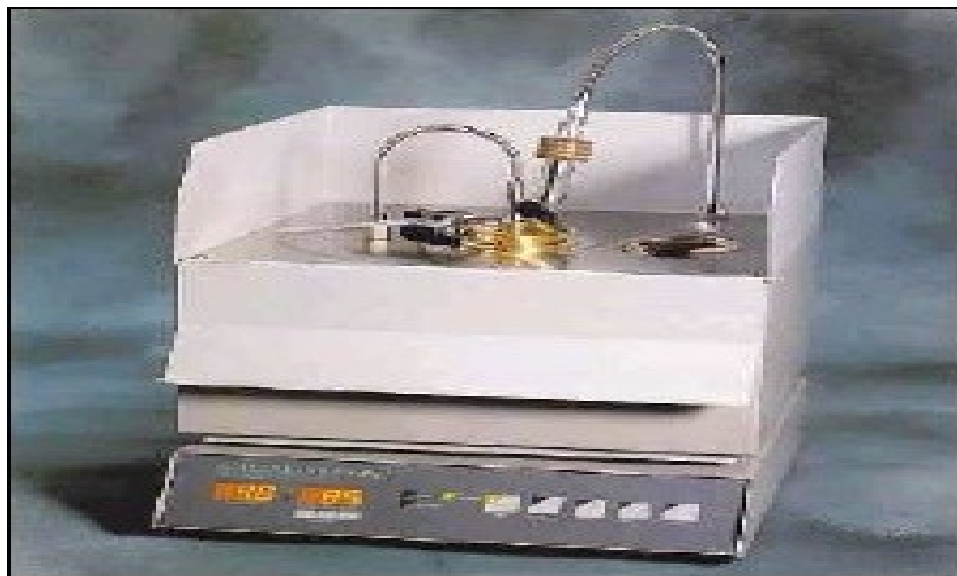
Figure II.13 : Auto flash GALLEKAMP utilisé dans la mesure du point d'éclair
