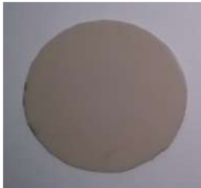
Figure 2.2 : Échantillon de PVC/B avant vieillissement
