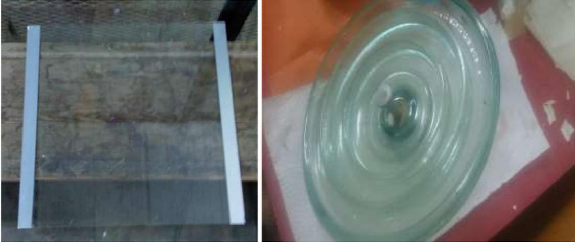
**Fig.2.2.** Modèle plan expérimental (à gauche) et l'élément de l'isolateur réel (à droite)
