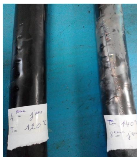
Fig. III.9 : Tronçons de câble complet avec la gaine du PVC après vieillissement
