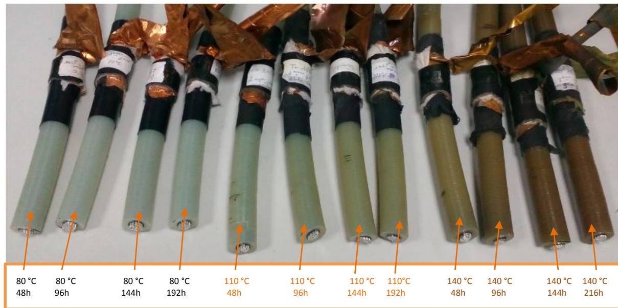
Fig. III.8 : Tronçons de câble complet 18/30 isolés par le PRC après vieillissement.
