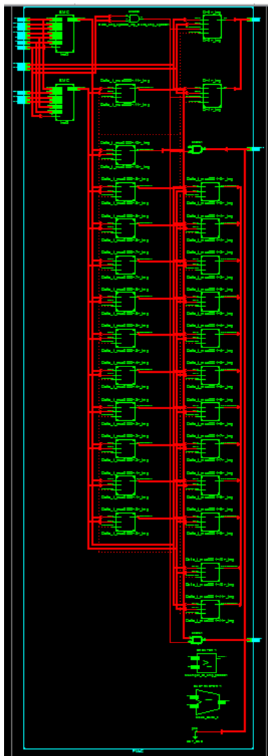
FIGURE 5.5 – Schématique du bloc de l'unité élémentaire de calcul des métriques de chemin (PMeC) générée par Xilinx-ISE.
