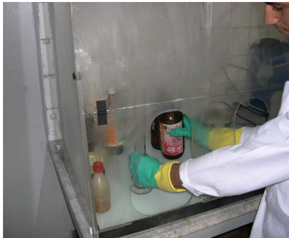
Figure 10 : Préparation de nital
