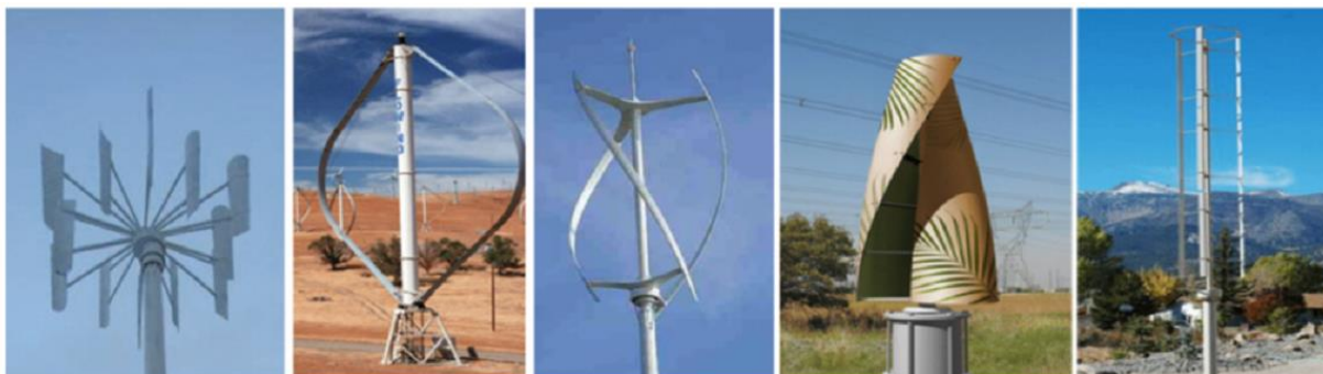
Figure 1-9 : Technologies d'éoliennes à axe vertical.
