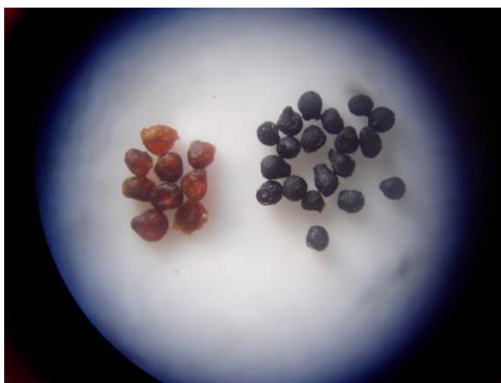
Fig. 3-13 : Coloration au bleu de méthylène des billes chitosane (marron), chitosane-AAc (bleu).
