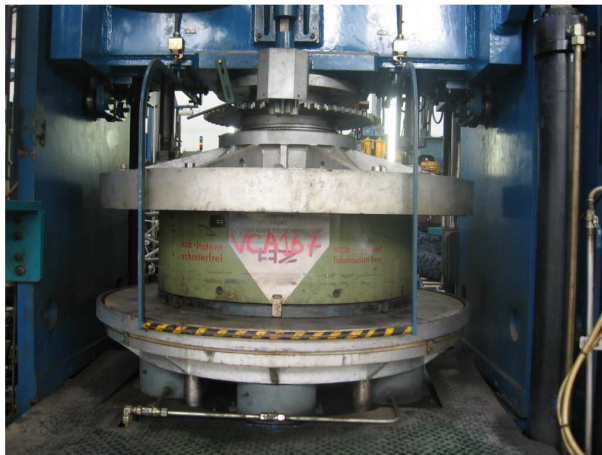
Figure 71 – Moule pour les petites dimensions.
