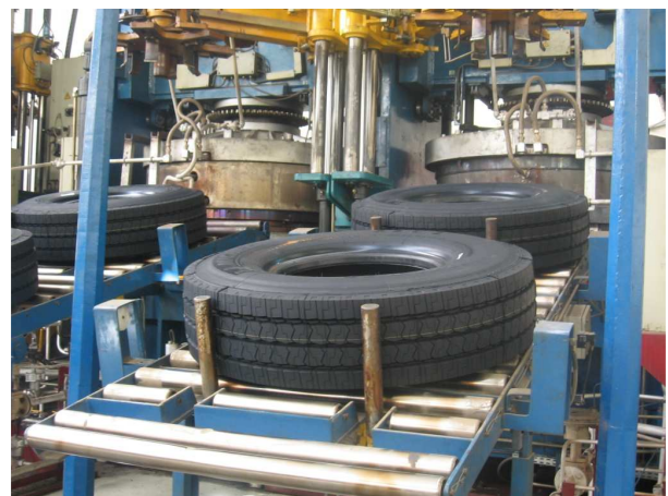
Figure 80 – Table de refroidissement.
