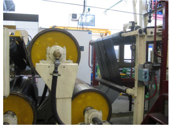
Figure 3 – Préparation des skims sur calandre.
